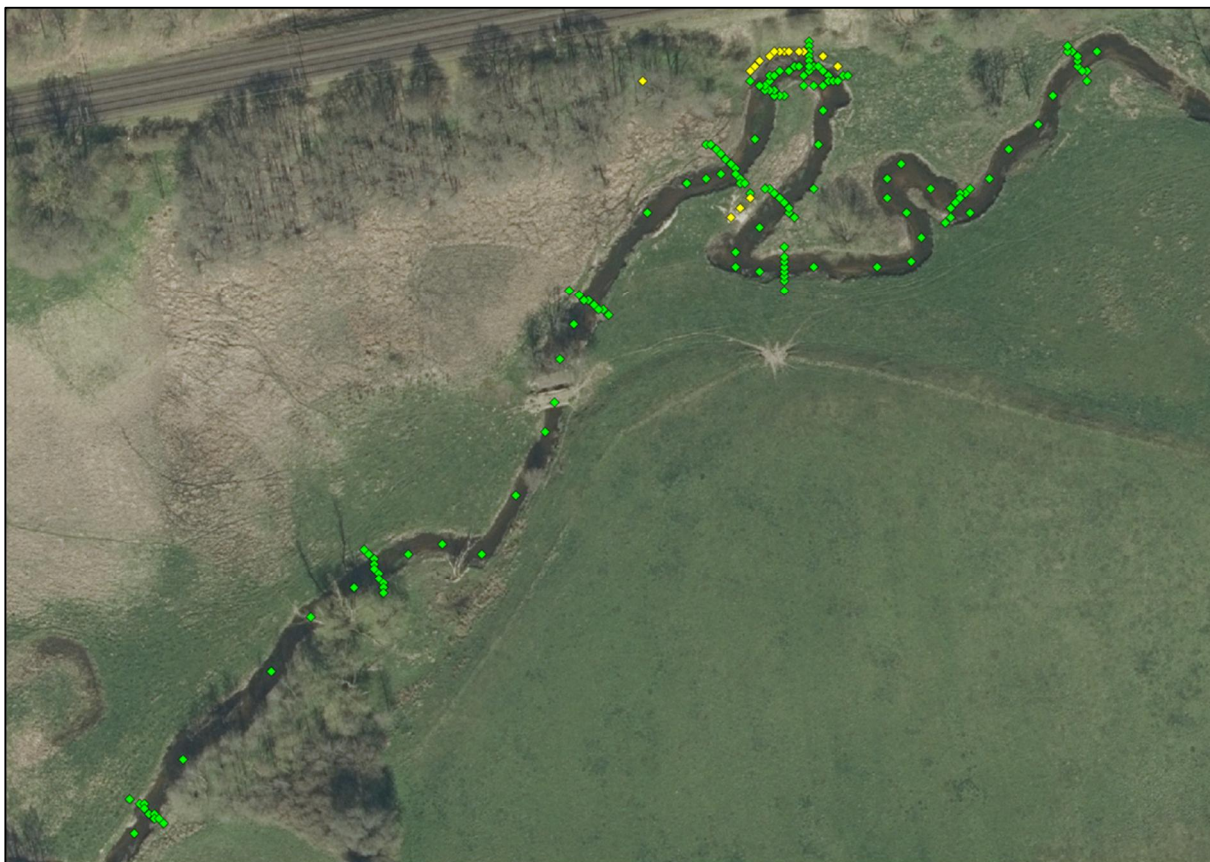
Figur 3-3. Opmålte punkter i vandløbet. Grøn: Vandløb. Gul: terræn m.v.
